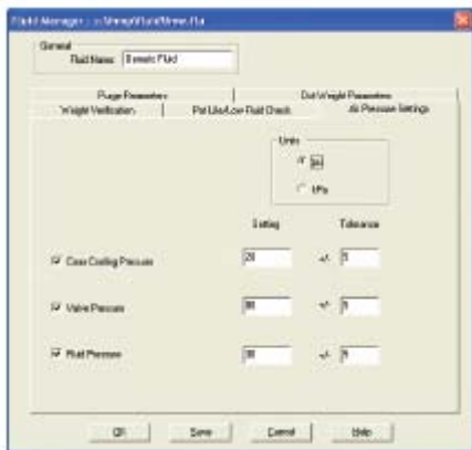
Los reguladores electroneumáticos controlan la presión de la válvula, del fluido y del refrigerante/coaxial. Los valores de presión se ajustan en el software FmXP y se controlan directamente en la pantalla de la computadora. Los manómetros se eliminan del panel frontal.
